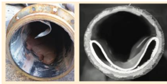
Сурет. 1. «Кессон эффектінің» көрінісі шыны талшықты құбырдағы қысымды босату кезінде
